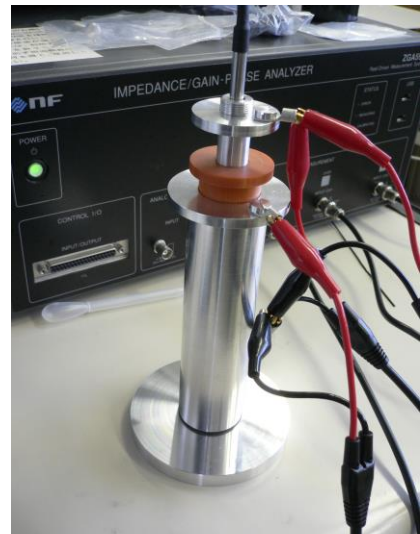
液体誘電率測定用簡易治具
